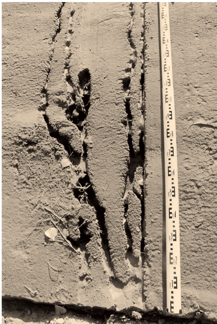
2 ábra Mesterséges esőztetés hatására kialakult barázdák döngölt löszön, 25% lejtésnél.
