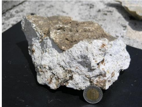
11. ábra. A 2. sz. porózus riolittufa makroszkópos képe (Fotó: McIntosh R.)
