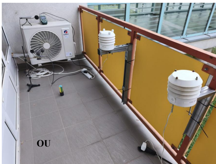
1. ábra A kültéri egységgel rendelkező erkély (OU) a mérőszensorokkal / Figure 1. Balcony equipped with an outdoor unit (OU) and measurement sensors
