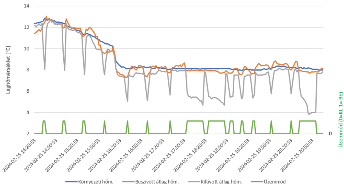
3. ábra: A beszívott, a kifúvott- és a környezeti levegő hőmérséklete az idő és az üzemmód függvényében/ Figure 3: Intake, exhaust and ambient air temperatures as a function of time and mode
