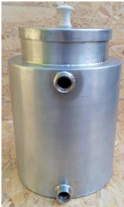
1. ábra A szoláris főzőedény Figure 1. The solar pot
