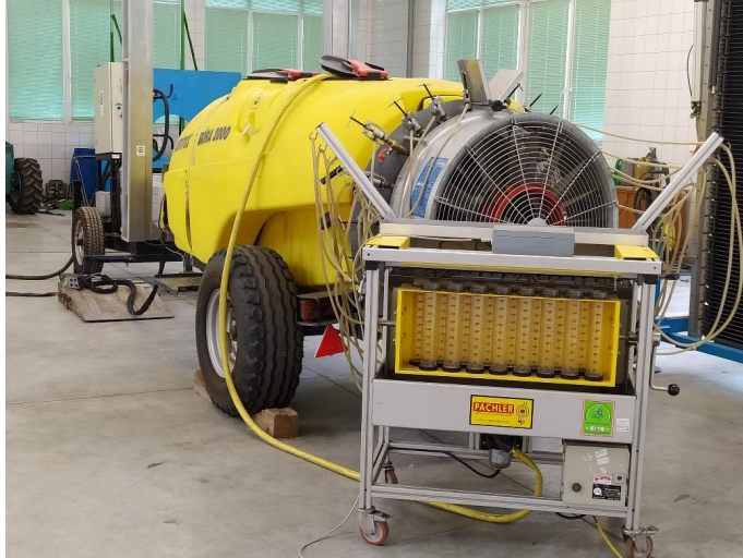
4. ábra Ültetvény permetezőgépek szóráskép-szimmetriájának mérése PACHLER EP-570 típusú berendezéssel
