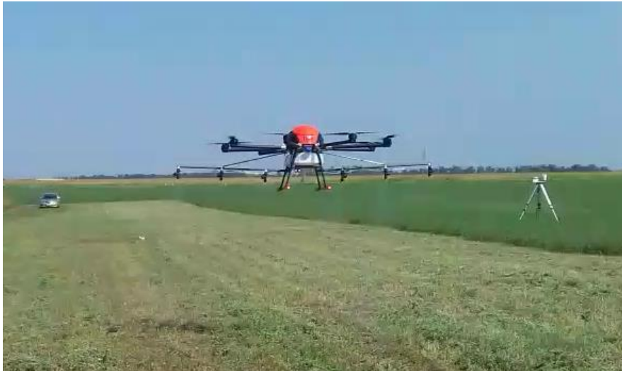
5. ábra Permetező drón munkaminőségi vizsgálata
