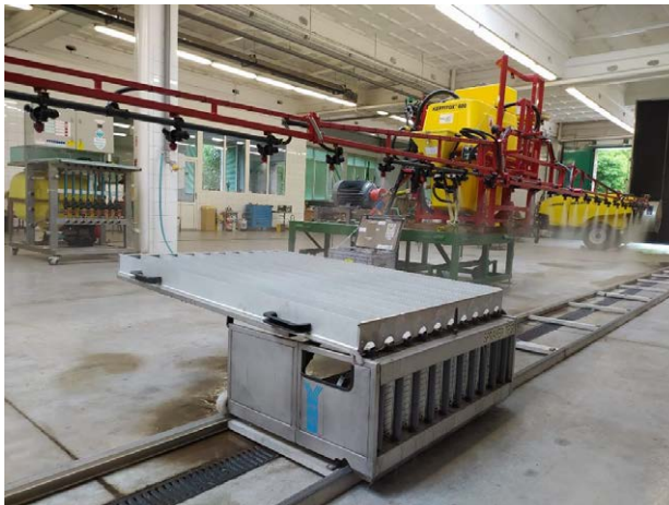
1. ábra Szántóföldi permetezőgép keresztirányú szórás egyenletességének meghatározása PESSL Sprayertest 1000 típusú mérőpaddal
