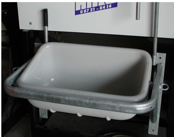
7. ábra: Villamos szintérzékelővel és mágnes-szelepes utántöltővel ellátott korszerű szintszabályozós önitató (ítatási helyzet)(Fotó: Tóth L.)
