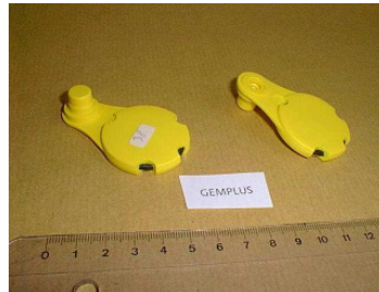
3. ábra: Fül krotáliába szerelt kivitel
