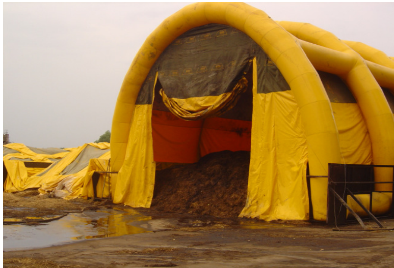
7. kép: A takarás leeresztett és felfújott állapotban (ATEVSZOLG Zrt., Győr)
