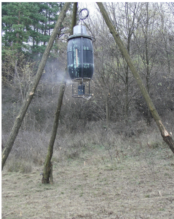
5. kép: Időpontra és mennyiségre is beállítható automata szemestakarmány szóró
