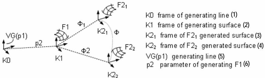
$\Phi$  – Connection parameters (*Kapcsolódás paramétere*),  $\Phi_1$ ,  $\Phi_2$  – Generating movement parameters (*Generáló mozgások paramétere*)
